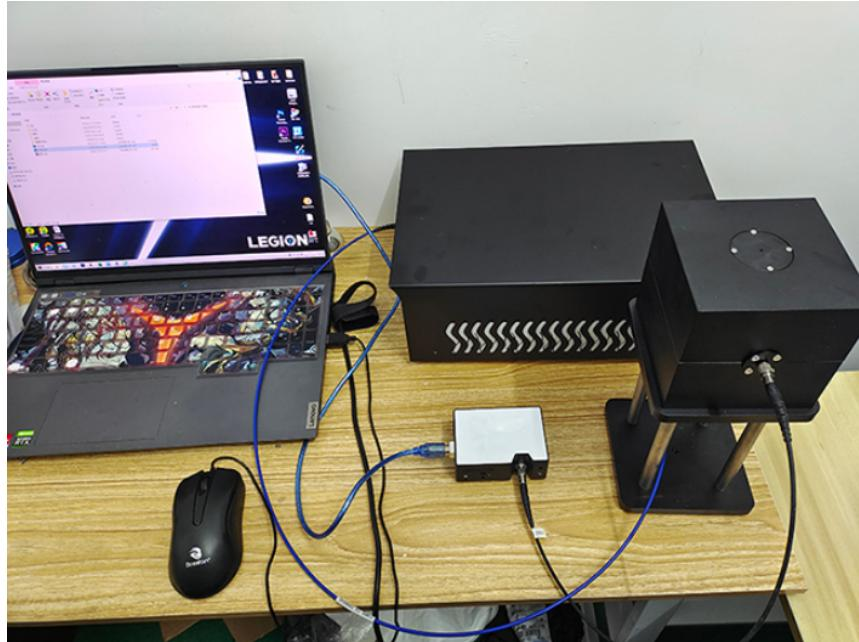
积分球测量法的原理是在积分球中先用标准参考灯定标，再测量被测灯，再由电脑进行比较处理的相对法测量。当被测灯与标准参考灯在各方面都相似时，误差就会减少到较小。但即使是这样，在实际的设备和测试过程中都会有很多因素使其产生偏离，更何况大多数被测灯与标准参考灯之间的差异很大。虽然有的因素偏离理想情况较少，单一因素对测量结果影响不大。但是偏离理想的因素太多，其交叉关联影响的可能性就会越大，误差也会越大。所以，应尽量减少设备和测试过程中的各种偏离。积分球测量法的原理是在积分球中先用标准参考灯定标，再测量被测灯。广州通用光度球一站式采购
