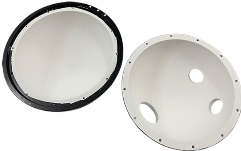
积分球球体的设计：显然，积分球球体肯定是越圆越好，这样就更能保证光线在其内部的每次反射都有不同路径，更易使光均匀。对于积分球球壁上开有 $2\pi$ 测量口的球体，当采用 $4\pi$ 方法测量时，其开口的挡板比较好的设计方法是挡板和球体有相同的球面度，这样当用挡板封贴在开口处时，挡板和球体可以形成一个完整的球面，对于光线的散射基本不造成影响。显然，有的积分球采用平面挡板封贴于 $2\pi$ 开口处，这样就严重破坏了球体的球面度，进而影响光线散射的均匀性。特别是当 $2\pi$ 开口比较大时，这种影响就更加明显。广州通用光度球一站式采购积分球涂料有哪些特性？
